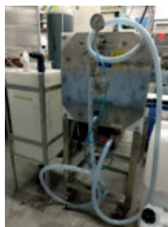
Station pilote de microfiltration pour l'élimination des solides en suspension dans les margines
