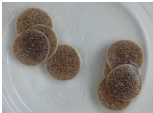
Support avec biofilm développé de réacteurs à lit fluidisé
