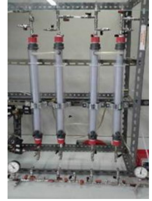
محطات تجريبية للترشيح الدقيق وامتصاص مياه الصرف من معاصر الزيتون
