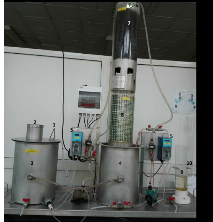
مفاعل في المختبر لمعالجة مياه الصرف الصحي البلدية.
